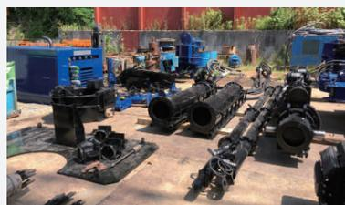
『山岳部での送電線基礎補強工事などにおいて、一般重機の搬入が困難な場所での杭打ち施工を可能とする』のコンセプトをもとに分解可能な小型杭打機『OTO® 掘削機』が2014年に発案されました。それからおよそ1年間の構想・開発を経て誕生したのがOTO-Type1。当時の送電線建替工事においてその実力を遺憾なく発揮しました。その後もお客様のニーズの変化に合わせて、各所の仕様を変更・調整し、2022年の現在ではOTO-Type5までの開発・運用が進んでおります。
