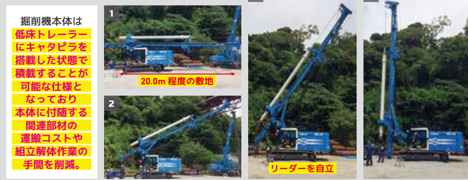
マルチドリル掘削機 (SR-45) 組立時体制図
