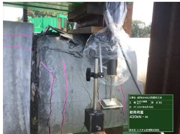
曲げ試験(試験後状況)
